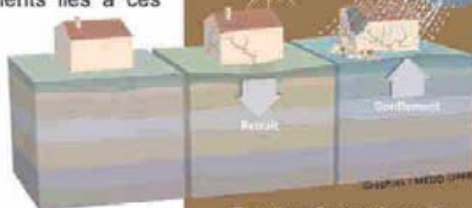
Retrait-gonflement des argiles
